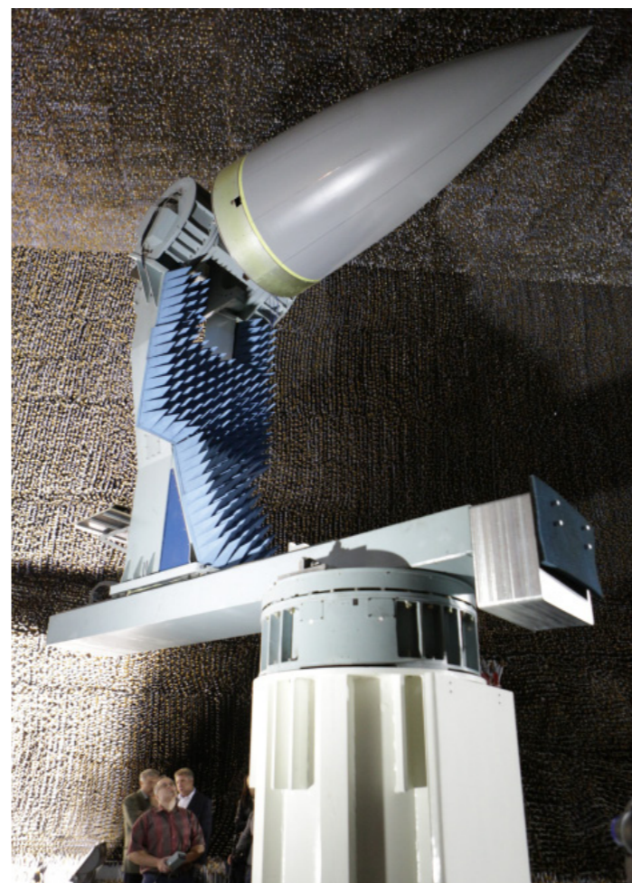
На фото: Оптимизация системы «антенна-обтекатель» современного самолета в безэховой камере
