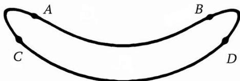
**Рис. 1.** Образующая кривая параболического зеркала со скруглениями
