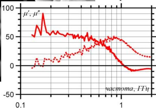
различным внешним воздействиям. По этой причине магнитодieleктрические КМ широко используют в радиочастотном и микроволновом диапазонах, в частности, в качестве радиопоглощающих покрытий (РПП).
